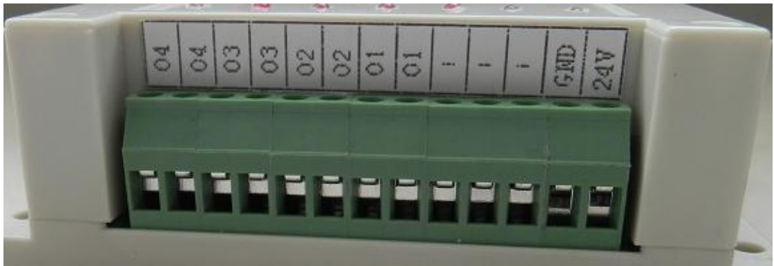
图二：COM1-开关输出及电源接线端子
